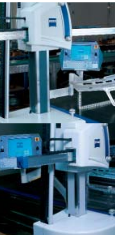
Ergonomie et utilisation simplifiée. Le bras articulé, réglable en hauteur et latéralement, peut être fixé sur les deux côtés de la machine
