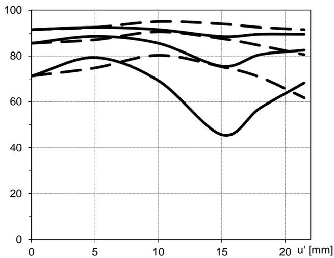
Modulationsübertragung MTF als Funktion der Bildhöhe ( $u'$ ) und Spaltorientierung. Weißes Licht. Ortsfrequenzen  $R=10, 20$  und  $40$  Perioden/mm. // Modulation transfer MTF as a function of the image height ( $u'$ ) and slit orientation. White light. Spatial frequencies  $R=10, 20$  and  $40$  cycles/mm.
