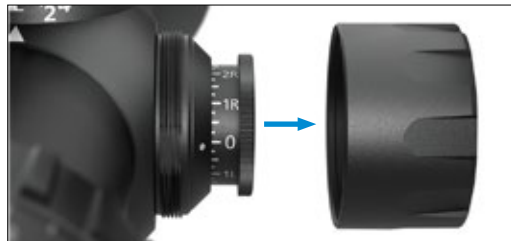
1c. Comme pour la tourelle d'élévation munie d'un capuchon, retirez la bague extérieure de la tourelle de dérive et faites-la tourner librement pour indexer la position zéro. Relâchez la bague extérieure de la tourelle.
