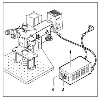
Fig. 3-5 Switch on the Axiotech<sup>vario</sup> 100 HD
